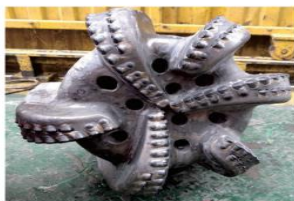
图 3 0444.5 mm MT616X 钻头起钻后照片
