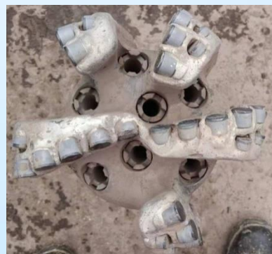
SM1-95井双摆II型提速工具+PDC组合两只钻头出井照片
