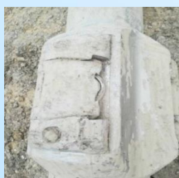
双摆+Power-V (出井) (井段1423-1990m、进尺567m、纯钻149h)
