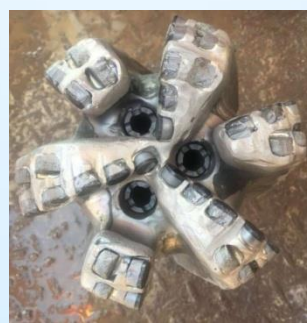
MaHW6207井、MaHW6209井水平井段单趟钻出井钻头对比
