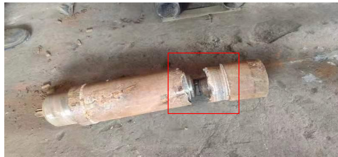
涡轮部分损坏 红线内为脱落的铁片部分
