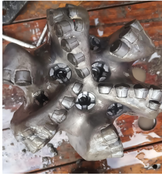
PDC钻头出井照片，施工井段 2507-3167m ，进尺 660m ，纯钻115.5h， 钻头新度80%。
