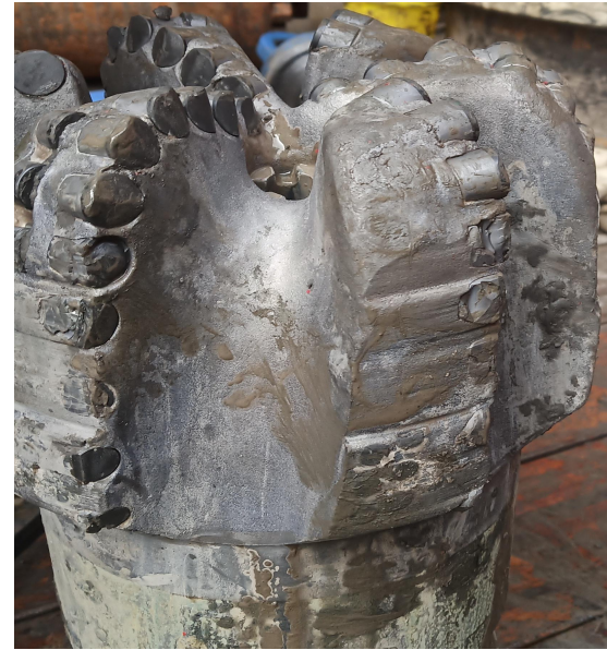
PDC钻头出井照片，施工井段 2507-3167m ，进尺 660m ，纯钻115.5h， 钻头新度80%。
